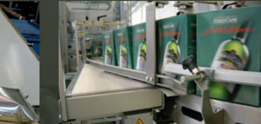
De færdigpakkede bag-in-box transporteres via et transportbånd til den automatiske pakkecelle, som er leveret af Sealing-System.
