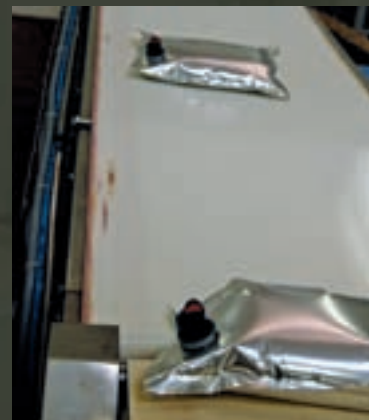
Vinen fyldes automatisk i poser, som så ligeledes placeres i boxen.
